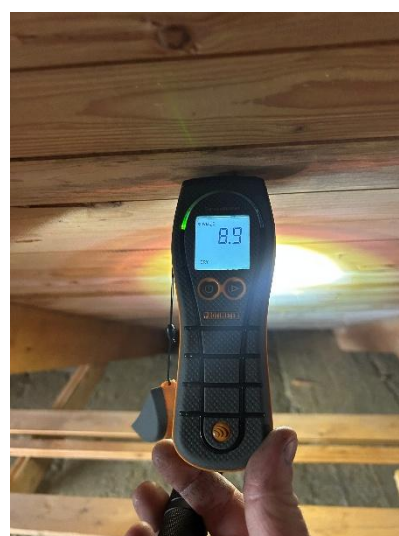
Vid stickprov i underlagstaket noterades 10,3%, 8,0% och 8,9%. Missfärgningar, microbiellpåväxt och fuktgenomslag.
