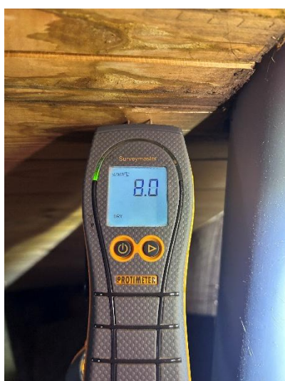
Vid stickprov i underlagstaket noterades 10,3%, 8,0% och 8,9%. Missfärgningar, microbiellpåväxt och fuktgenomslag.
